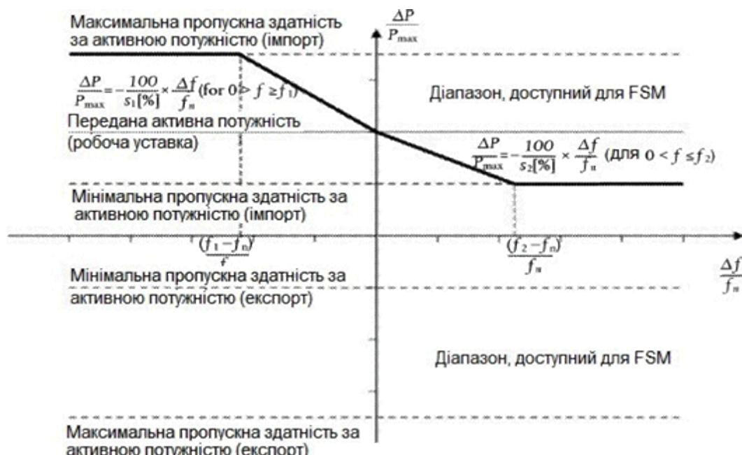
Рисунок ілюструє випадок нульової зони нечутливості і нечутливості з позитивною уставкою активної потужності (режим імпортування).  $\Delta P$  - зміна вихідної активної потужності системи ПСВН.  $f_n$  - цільова частота в мережі ЗС, де надається послуга FSM, а  $\Delta f$  - відхилення частоти в мережі ЗС, де надається послуга FSM.
