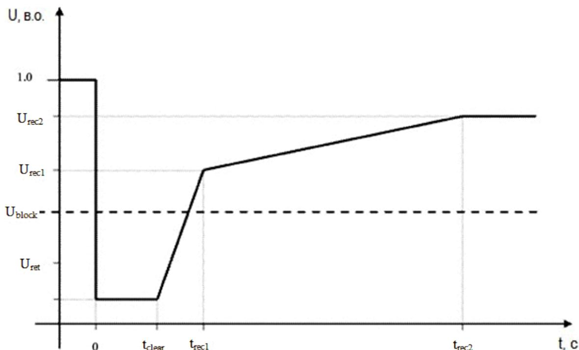
$U_{ret}$  - залишкова напруга в точці приєднання під час пошкодження,  $t_{clear}$  - момент, коли пошкодження ліквідовано,  $U_{rec1}$  і  $t_{rec1}$  вказують точку більш низьких меж відновлення напруги після ліквідації пошкодження.  $U_{block}$  - блокувальна напруга в точці приєднання. Згадувані значення часу вимірюються від  $t_{fault}$ .
