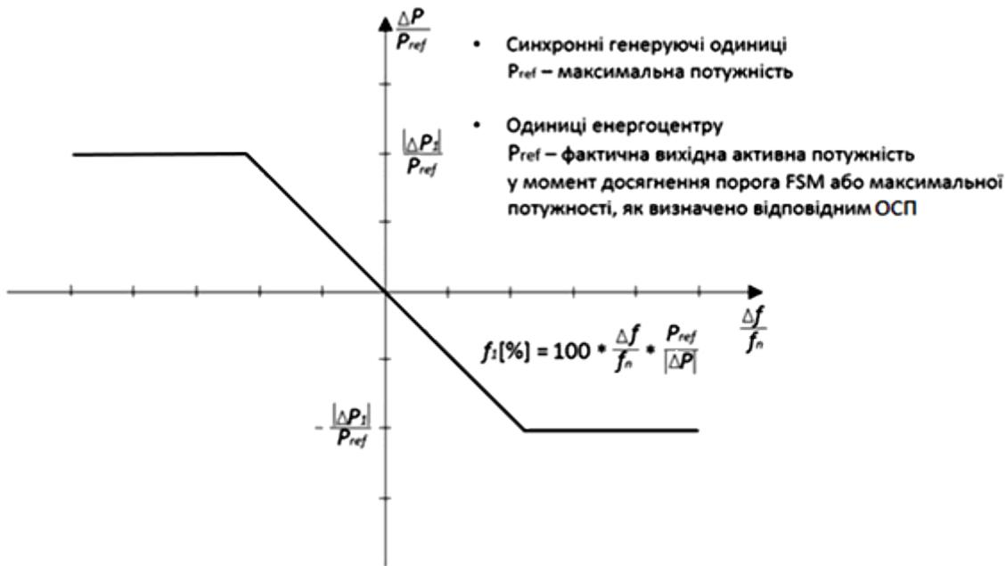
$P_{ref}$  - базова активна потужність, до якої відноситься  $\Delta P$ ;  $\Delta P$  - зміна вихідної активної потужності генеруючої одиниці;  $f_n$  - номінальна частота (50 Гц) у мережі;  $\Delta f$  - відхилення від номінальної частоти в мережі.
