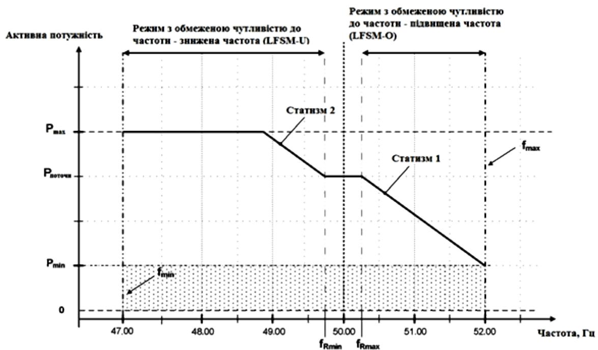
$P_{\max}$ ,  $P_{\min}$  - максимальний, мінімальний технічний рівень потужності генеруючої одиниці;  $P_{\text{поточ}}$  - поточний рівень потужності.  $f_{R\min}$ ,  $f_{R\max}$  - мінімальне, максимальне значення зони нечутливості по частоті;  $f_{\min}$ ,  $f_{\max}$  мінімальна, максимальна допустима частота роботи генеруючої одиниці.
