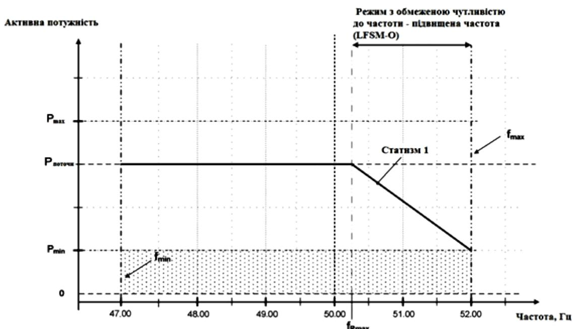
$P_{\max}$ ,  $P_{\min}$  - максимальний, мінімальний технічний рівень потужності генеруючої одиниці;  $P_{\text{поточ}}$  - поточний рівень потужності;  $f_{R\max}$  - максимальне значення зони нечутливості по частоті;  $f_{\min}$ ,  $f_{\max}$  мінімальна, максимальна допустима частота роботи генеруючої одиниці.
