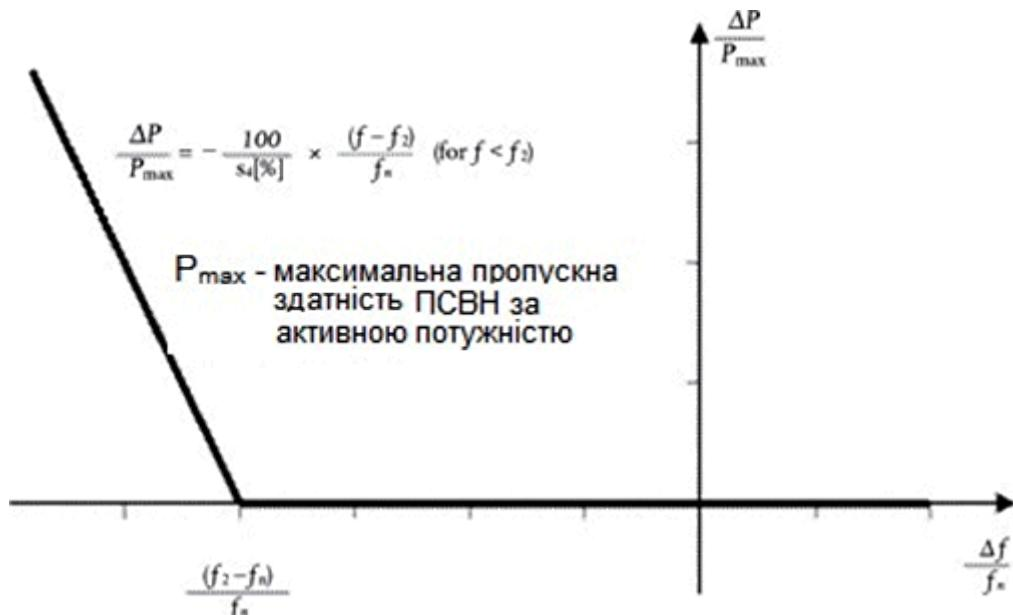
$\Delta P$  - зміна вихідної активної потужності системи ПСВН і залежно від робочих режимів зменшення імпортованої потужності або збільшення експортованої потужності.  $f_n$  - номінальна частота в мережі або мережах ЗС, до яких приєднана система ПСВН, а  $\Delta f$  - зміна частоти в мережі або мережах ЗС, до яких приєднана система ПСВН. За знижених частот, коли  $f$  нижче  $f_2$ , система ПСВН повинна збільшувати вихідну активну потужність відповідно до уставки статизму  $s_4$ .
