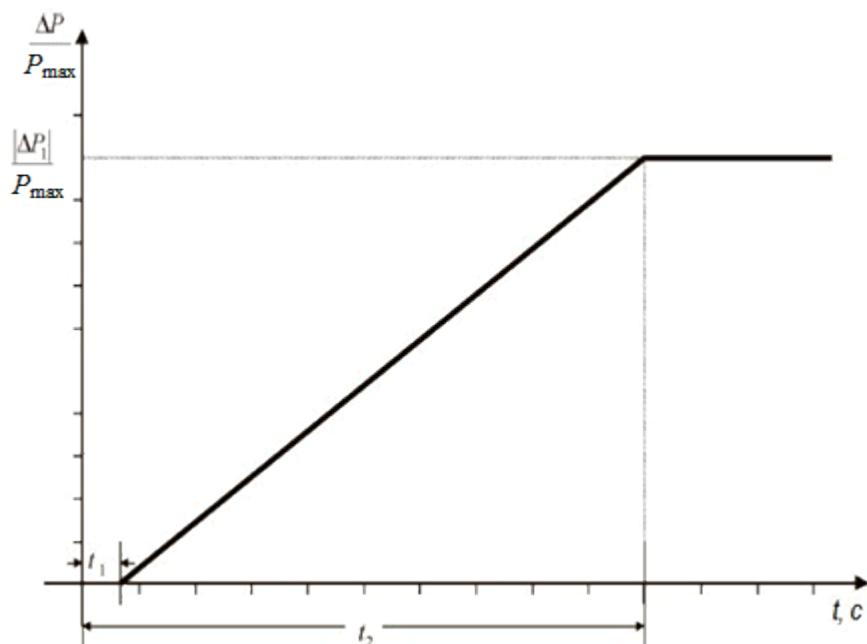
$P_{\max}$  - максимальна потужність, до якої відноситься  $\Delta P$ ;  $\Delta P$  - зміна вихідної активної потужності генеруючої одиниці. Генеруюча одиниця має забезпечувати вихідну активну потужність  $\Delta P$  до точки  $\Delta P_1$  відповідно до інтервалів часу  $t_1$  і  $t_2$  зі значеннями  $\Delta P_1$ ,  $t_1$  і  $t_2$ , визначених ОСП відповідно до таблиці 6;  $t_1$  - початкова затримка;  $t_2$  - час повної активації.
