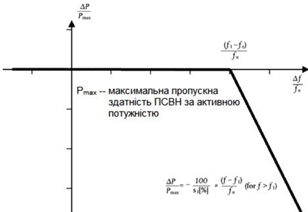
$\Delta P$  - зміна вихідної активної потужності системи ПСВН і залежно від робочих режимів зменшення імпортованої потужності або збільшення експортованої потужності.  $f_n$  - номінальна частота мережі або мереж ЗС, до яких приєднана система ПСВН, а  $\Delta f$  - зміна частоти в мережі або мережах ЗС, до яких приєднана система ПСВН. За підвищених частот, коли  $f$  перевищує  $f_1$ , система ПСВН повинна зменшувати активну потужність відповідно до уставки статизму.
