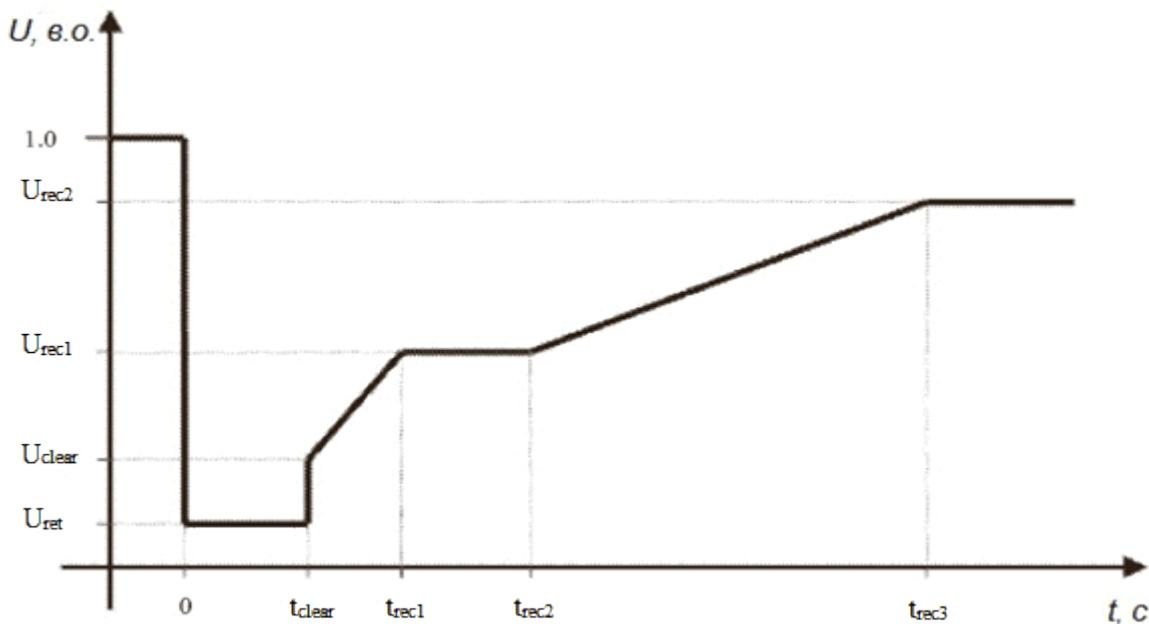
На графіку показана нижня межа кривої напруги в залежності від часу для напруги в точці приєднання, вираженої як відношення її фактичного значення до її опорного значення у в. о. - до, упродовж і після пошкодження.  $U_{ret}$  - залишкова напруга в точці приєднання впродовж КЗ,  $t_{clear}$  - момент ліквідації КЗ.  $U_{clear}$ ,  $U_{rec1}$ ,  $U_{rec2}$ ,  $t_{rec1}$ ,  $t_{rec2}$  і  $t_{rec3}$  - вказують на певні точки нижніх меж відновлення напруги після ліквідації КЗ.
