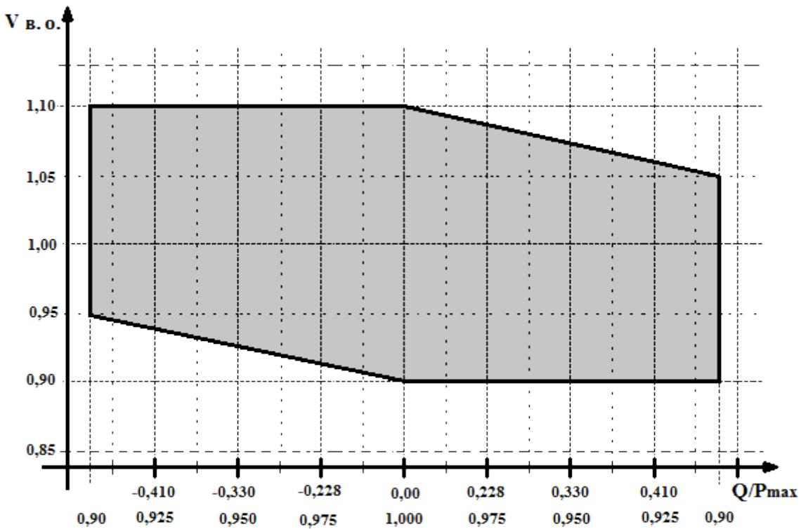
Діаграма відображає межі графіка  $U-Q/P_{\max}$  напругою в точці приєднання, вираженою відношенням її фактичного значення до її опорного значення у в. о., у залежності від відношення реактивної потужності ( $Q$ ) до максимальної потужності ( $P_{\max}$ ).
